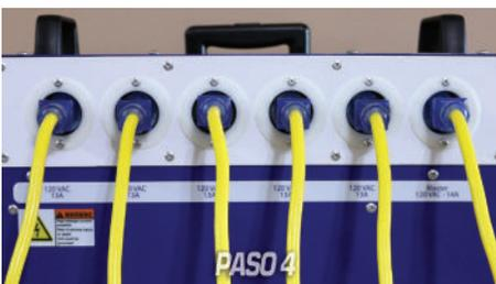
Enchufe un lado de un cable con el maquina y el otro lado con el interruptor automático de 20-amperaje. Repita esto con los otros cinco cables y use un interruptor automático de 20 amperaje dedicado para cada clavija (no use la toma de corriente. Deba usar los interruptores automáticos). Durante el proceso de calentar, es imperativo que no amonte ropa, peluches, o mantas en un montón. El proceso debe ser embolsar todo posible y tomarlo a una lavandería.
