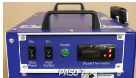
Ahora todo está listo para encender la maquina y el ventilador. Hay que mantener la maquina encendida hasta que la temperatura alcance 130 grados y hay que mantener esa temperatura por 3 horas más. Después de este proceso, apague los espirales calefactores y deje que el ventilador quede puesto por 15 minutos. **No Cambie El Termostato O La Garantía Será Invalido.** Las personas deben salir del cuarto mientras el cuarto recibe el tratamiento.
